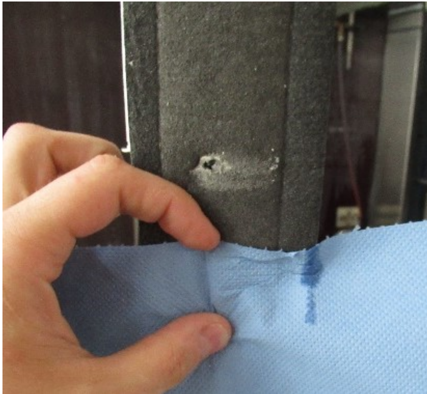
Bild 13 Überprüfung der Wassereindringtiefe in das Hannoband®-3E EASY mit Hilfe des hellblauen Industriekrepp-Papiers an der unteren rechten Ecke (von außen betrachtet): Das Wasser konnte nur einige Millimeter ins Material eindringen
