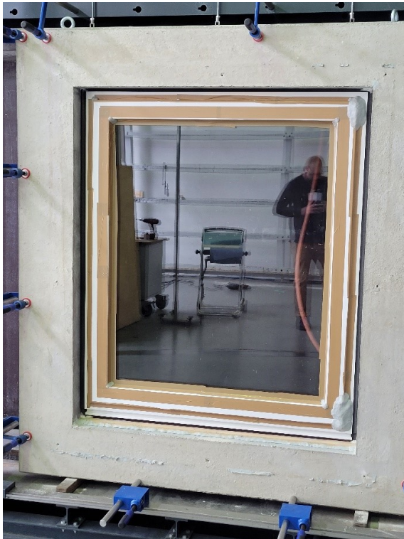
Bild 1 Ansicht des Bauteilrahmens bei der Eingangsprüfung im Neuzustand; Fensterfugen sind luftdicht abgeklebt
