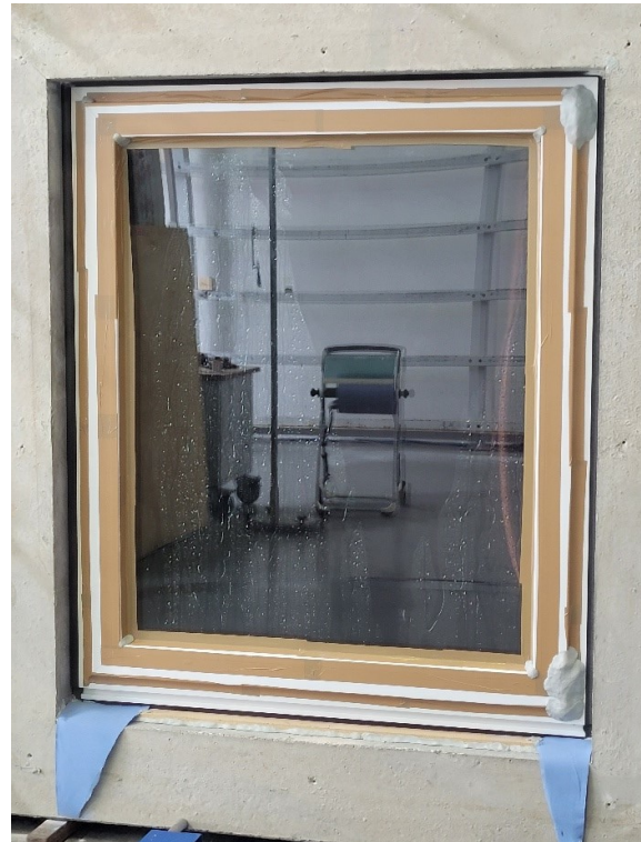
Bild 2 Ansicht des Probekörpers bei der Schlagregenprüfung
