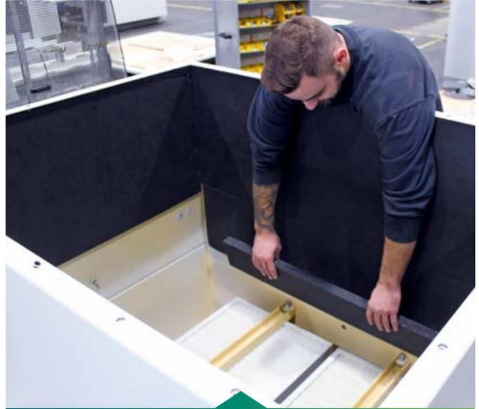
HANNO-Produkte entkoppeln Bauteile und verhindern so, dass sich Körperschall überträgt. Dadurch laufen Maschinen und Geräte deutlich leiser.
