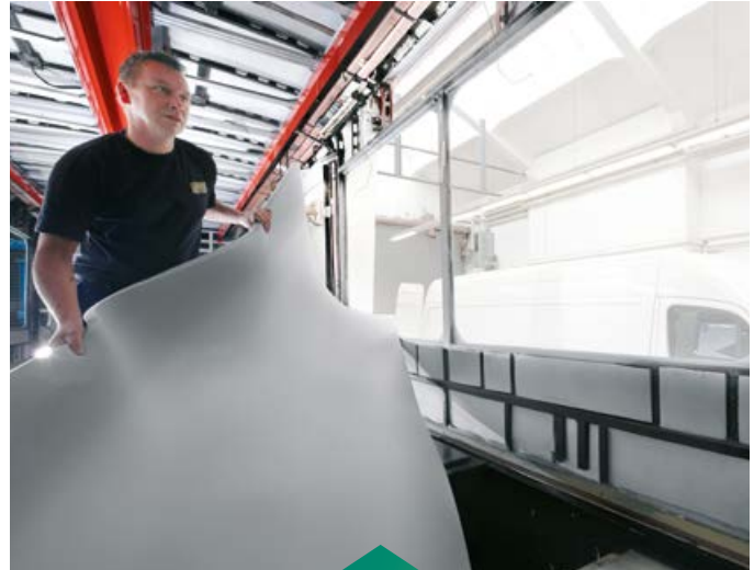
HANNO fertigt Stanzteile aus Schaumstoff für den Lärmschutz und die Wärmeisolierung in Zügen und Straßenbahnen
