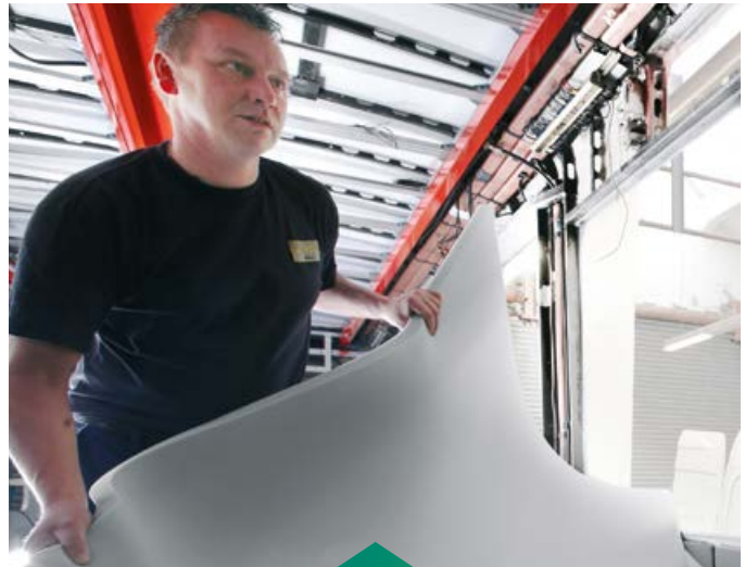
HANNO fertigt Stanzteile aus Schaumstoff für den Lärmschutz und die Wärmeisolierung in Automobilen
