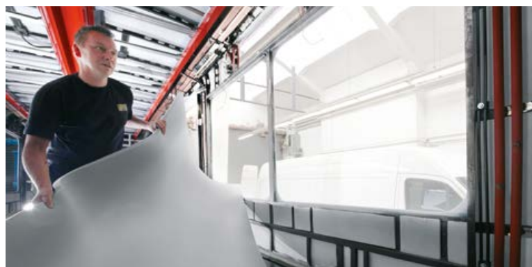
HANNO fertigt Stanzteile aus Schaumstoff für den Lärmschutz und die Wärmeisolierung in Zügen und Straßenbahnen
